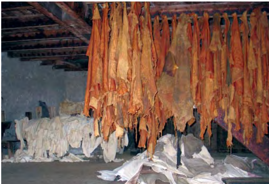
Lederverarbeitung: Trocknen nach dem Gerbevorgang
