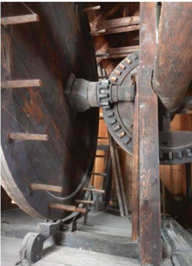
Hebemechanik in der Pulvermühlschleuse
